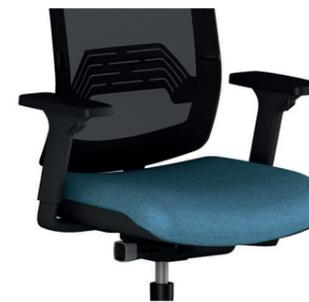
Mécanisme synchro autorégulé s'adaptant automatiquement au poids de l'utilisateur avec limiteur de course dans 3 positions (inclinaison du dossier bloquée à 0 degré ou libre avec choix d'angle à 10 ou 20 degrés) et 2 possibilités de dureté pour ceux qui préfèrent un soutien tonique ou au contraire plus souple.
